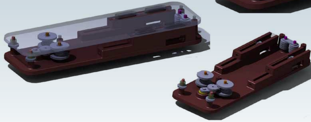
Bild 4: Im nächsten Entwicklungsschritt wird der rotatorische Schrittantrieb nach dem 4-Takt-Prinzip optimiert, zudem wird eine deutliche Reduzierung der Baugröße umgesetzt
